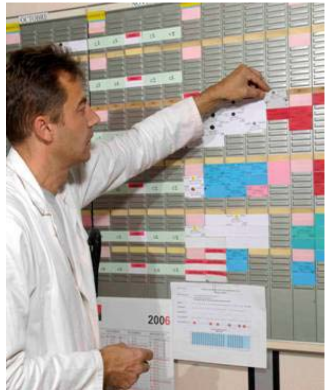
Planification de fabrication : Regroupement des campagnes de couleurs afin de réduire les rebus de démarrage de production. (crédit photo Stéphane Leitenberger/ADEME)
