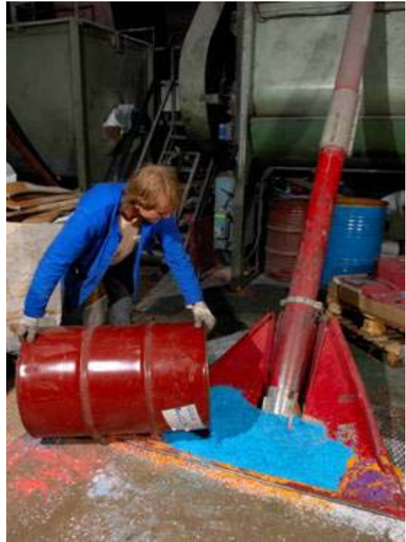
Atelier broyage : Aspiration pour alimenter un mélangeur. Le mélange sera utilisé des produits de sous catégorie. (crédit photo Stéphane Leitenberger/ADEME)
