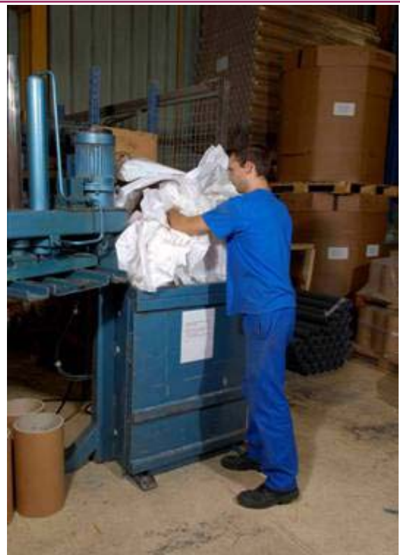
Incorporation des sacs plastiques vides dans une presse à balles. (crédit photo Stéphane Leitenberger/ADEME)
