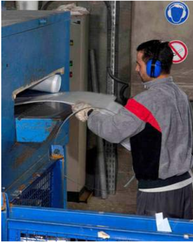
Atelier broyage : broyage des chutes, rives, non conformes, pour recyclage (crédit photo Stéphane Leitenberger/ADEME)
