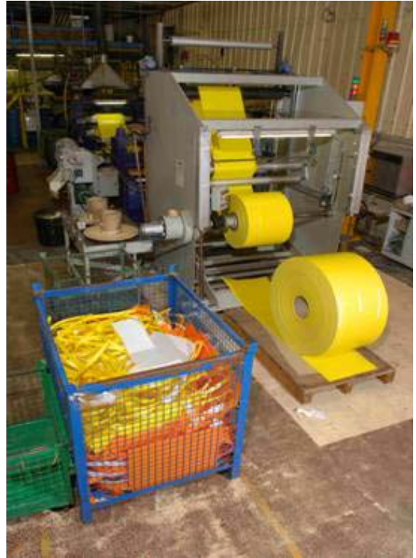
Ligne d'extrusion : bobine de feuille plastique et bac de récupération de chutes et rives destinées à être recyclées. (crédit photo Stéphane Leitenberger/ADEME)
